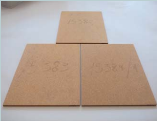
Abb. 1: MDF aus zellulosefaserhaltigem Fasermaterial (Anteile: oben: 0 %, unten links: 25 %, unten rechts: 50 %) und Kiefernfasermaterial
