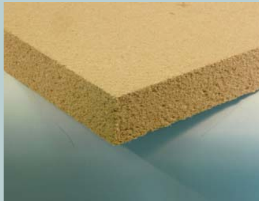
Abb. 2: Halbzeug aus zellulosefaserhaltigem Fasermaterial (Anteil 25 %) und Kiefernfasermaterial
