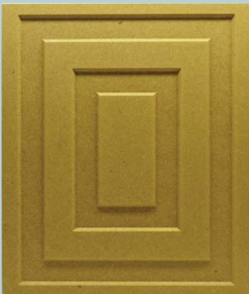
Abb. 3: Möbelfrontelement aus zellulosefaserhaltigem Fasermaterial (Anteil 25 %) und Kiefernfasermaterial (links ohne, rechts mit Beschichtung)
