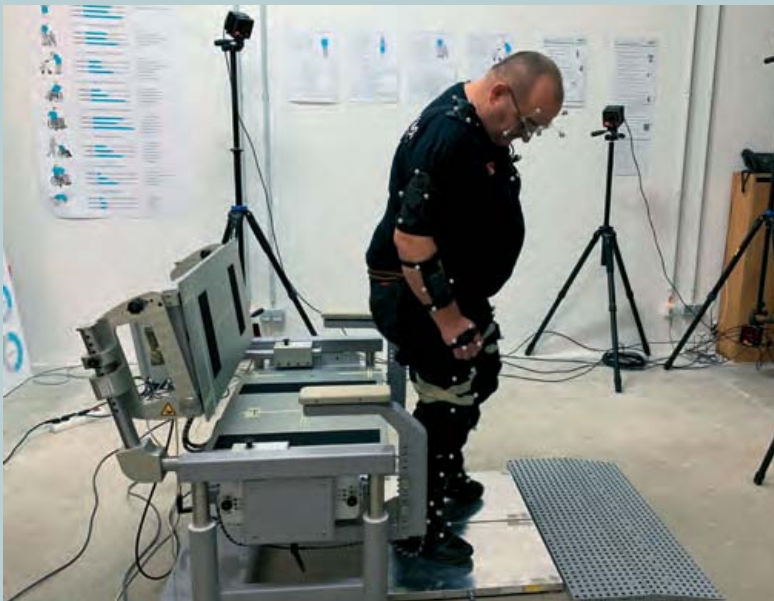
Abb. 1: Proband beim Versuchsdurchlauf mit dem Messstuhl in Kombination mit dem Motion Capture System
