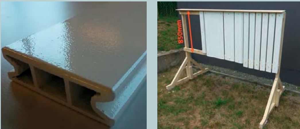
Abb. 1: Leitfähiges WPC mit 2-Schicht-Pulverlackierung (links); Versuchsstand mit pulverlackierten Balkenelementen in der Freibewitterung (rechts)
