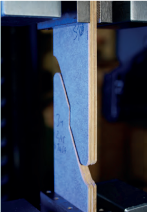
Abb. 2: Prüfaufbau des Scherversuches mit verstärktem Prüfkörper
