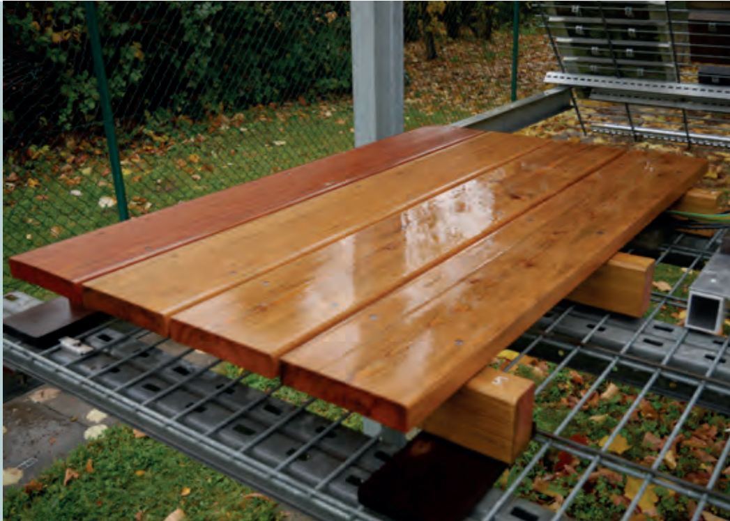
Abb. 2: Wasserfilm bei 2 % Gefälle nach Regen
