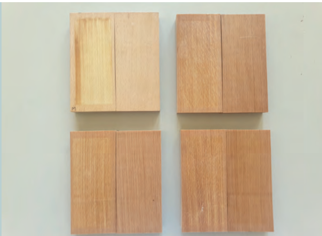
Abb. 1: Gegenüberstellung der bewitterten (belichteten) Proben links mit den nicht bewitterten (belichteten Proben) rechts. Es wird deutlich, dass mit den vergüteten Proben (unten) messbare Farbänderungen auftraten, die aber geringer ausfielen als bei naturbelassenem Buchenholz
