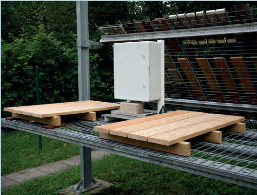
Abb. 1: Belagsroste mit 0 % und 2 % Gefälle im Test
