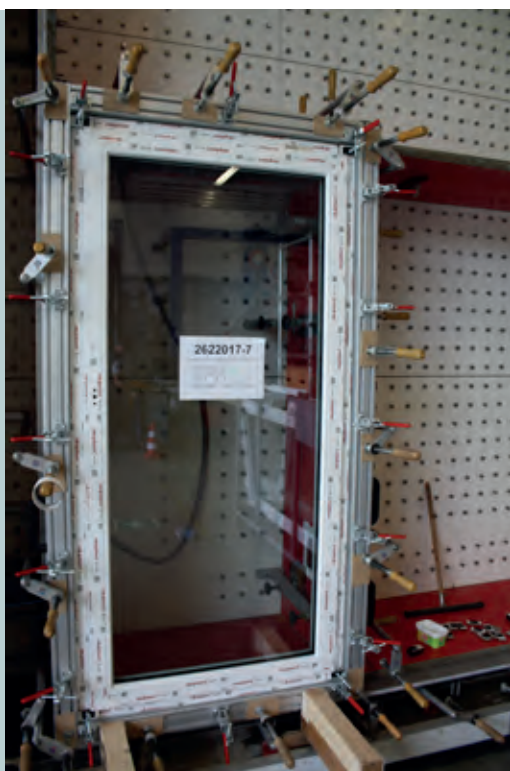
Abb: 1: Prüfung der Gebrauchstauglichkeit von Bauelementen mit dem neuen Wechselrahmen aus Aluminium
