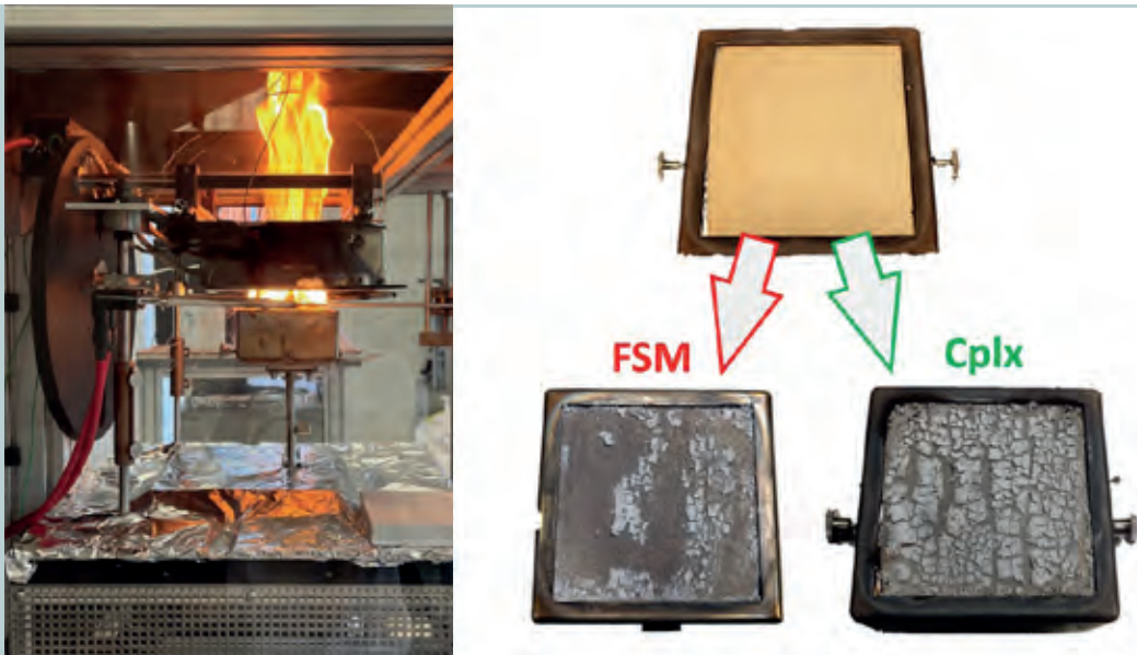
Abb. 2: Cone-Kalorimeter (links) und Prüfkörper mit beschichteter Fichtenfurnieroberfläche mit konventionellem Flamschutzmittel (FSM) und neuartigem Wirt-Gast-Komplex (Cplx) vor und nach der Brandprüfung (rechts)
