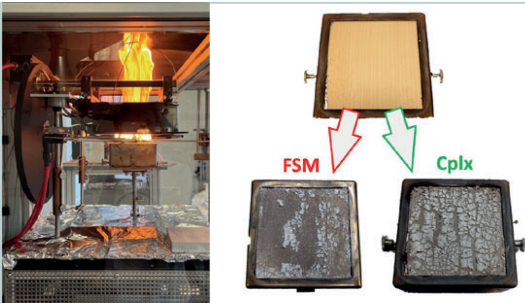
Abb. 2: Cone-Kalorimeter (links) und Prüfkörper mit beschichteter Fichtenfurnieroberfläche mit konventionellem Flammenschutzmittel (FSM) und neuartigem Wirt-Gast-Komplex (Cplx) vor und nach der Brandprüfung (rechts)
