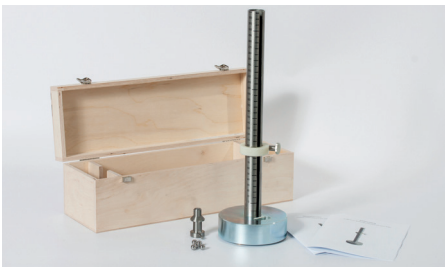
Stoßfestigkeitsgerät nach EN 17368 für Laminatfußböden
