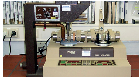
Bestimmung der Abriebfestigkeit mittels Taber Abraser mit integriertem Grit Feeder (Falling Sand-Verfahren)
