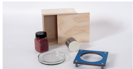
Prüfvorrichtung zur Bestimmung der Verschmutzungsneigung nach IHD-W-477
