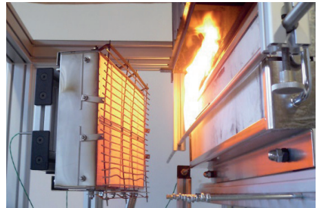
Prüfstand gemäß FTP Code 2010 zur Bestimmung der Oberflächenentflammbarkeit (Schiffsinnenausbau)
