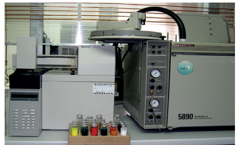
Bestimmung des VOC-Gehaltes mittels Head-Space-Apparatur mit GC/FID
