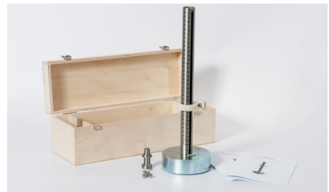
Stoßfestigkeitsgerät nach EN 17368 für Laminatfußböden
