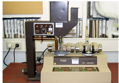
Bestimmung der Abriebfestigkeit mittels Taber Abraser mit integriertem Grit Feeder (Falling Sand-Verfahren)
