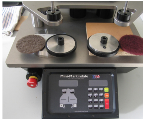
Prüfgerät für das Aufpolierverhalten nach IHD-W-475
