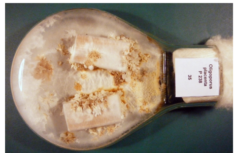
Pilzprüfung von thermisch modifiziertem Holz (TMT)
