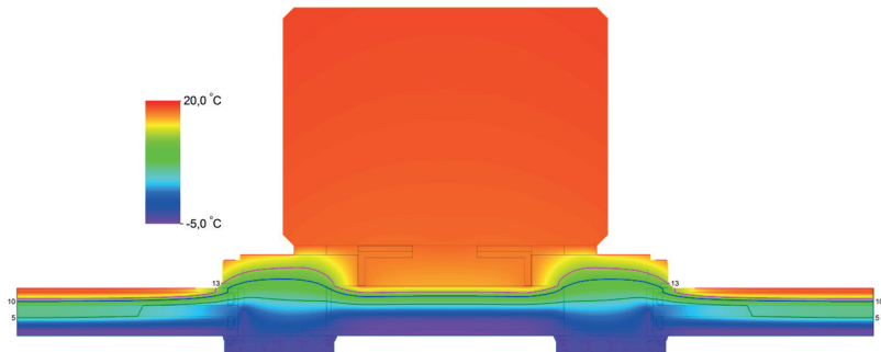
Isothermverlauf in einer Pfosten-Riegel-Konstruktion
