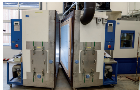
Differenzklimaprüfung an Fenstern
