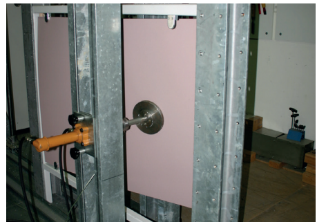
Prüfung von absturzsichernden Bauteilen
