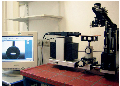
Randwinkelmessung zur Bestimmung der Oberflächenspannung
