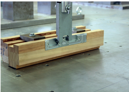
Prüfung des Haltevermögens von Beschlägen
