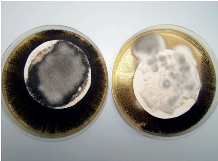
Prüfung der Wirksamkeit von Filmschutzmitteln in Beschichtungsstoffen gegen Pilze nach DIN EN 15457
