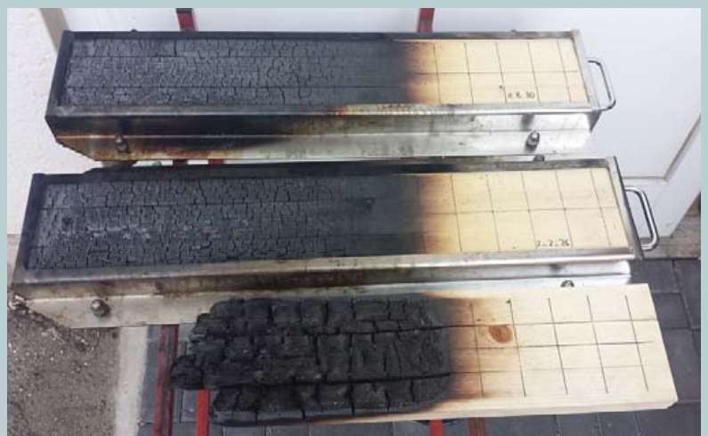
Abb. 2: FSM imprägnierte Fichte (oben, Mitte) sowie Referenz (unbehandelt, unten) nach Brandprüfung gemäß IMO 5(1) IMO Res. MSC. 307 (88) FTP Code 2010, Anlage 1, Teil 5 (IMO 5[1])
